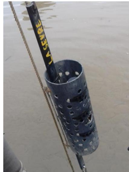
Figure 16 : Mise en place d'une sonde STPS
