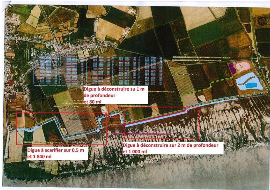
**Figure 30** : Plan des reprises de digue sur le secteur Ouest de Charron (source SIEAGH du Curé)
