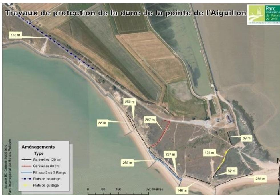
**Figure 25** : Carte des travaux d'octobre 2012 à la pointe de l'Aiguillon
