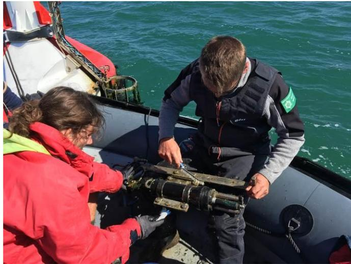
*Nettoyage de la sonde du PNM installée sur la bouée d'Eaux saines de la Sèvre.*
