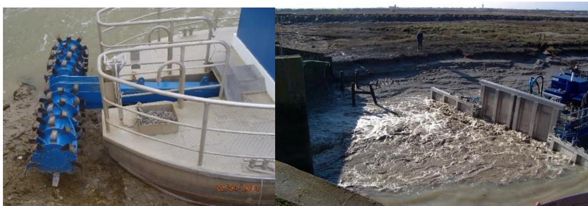
**Figure 28 : équipements du bateau dévasoir. Fraise de rotodévasage à la proue (gauche). Râteau de baccage à la poupe (droite).**
